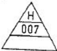
Die Klebmarke enthält im oberen Feld den Kennbuchstaben der zuständigen Behörde, im mittleren Feld eine dem Instandsetzer zugeteilte Nummer. Das untere Feld ist für die Angabe des Datums der Instandsetzung bestimmt. Die Farbe des Feldes der Klebmarke ist signalrot, die Farbe von Schrift und Zeichen ist schwarz.
